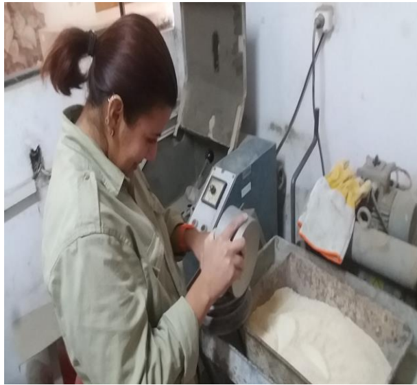
Figura 4. Molino de disco utilizado para disminuir el tamaño de los materiales obtenidos de la trituradora.
