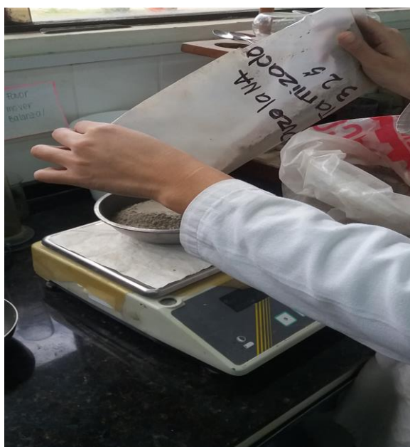
Figura 9. Pesado de materiales para su posterior mezcla.
