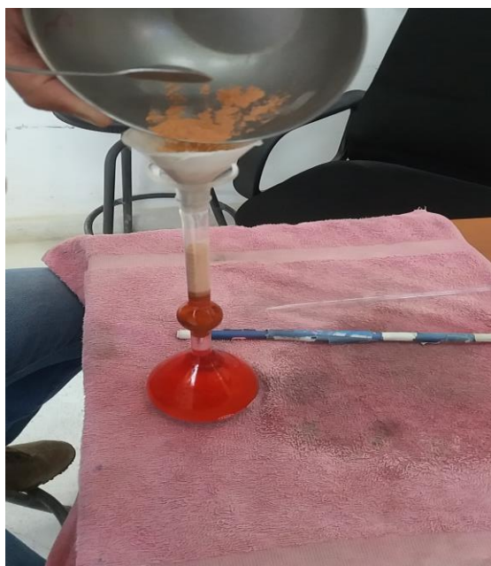
Figura 8. Frasco de Le Chatelier utilizado para obtener la densidad de cada material.
