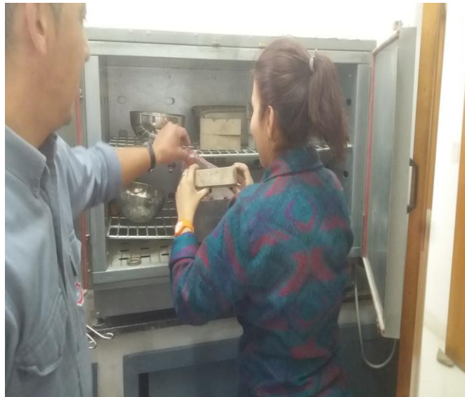
Figura 14. Probetas extraídas de la estufa después de 28 días para la determinación del índice de puzolanidad.
