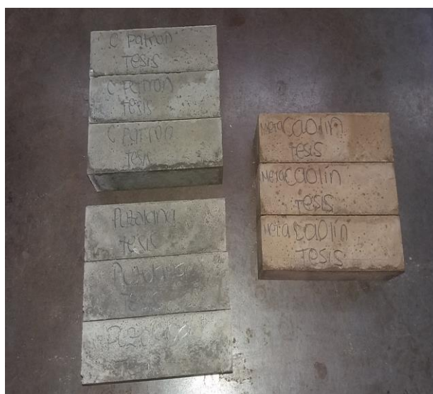
Figura 12. Moldes prismáticos de cemento patrón, cemento patrón con puzolana y cemento patrón con caolín calcinado.
