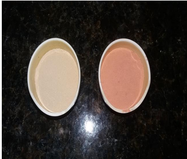
Figura 6. Crisoles conteniendo caolín sin calcinar y caolín calcinado.
