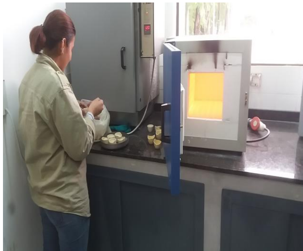
Figura 5. Mufla de calcinación (hasta 900°C) para muestras de caolín.
