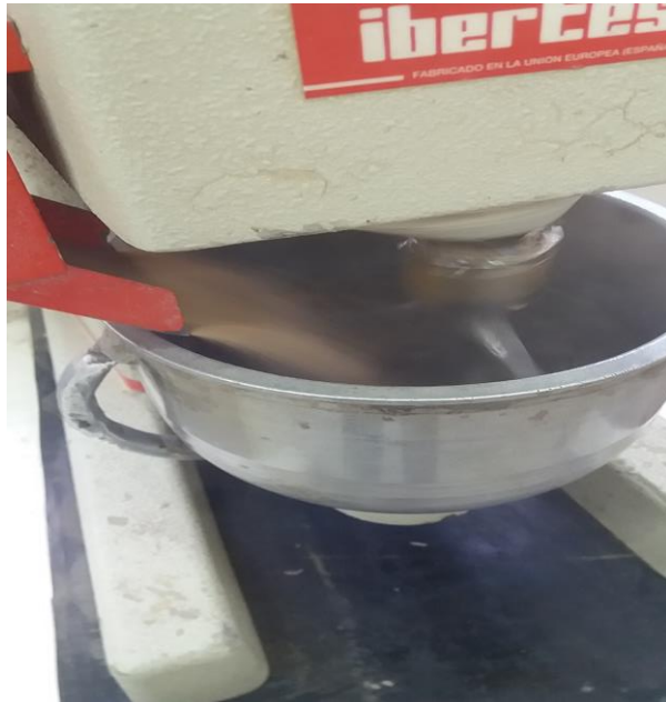
Figura 10. Maquina mezcladora de homogenización para la pasta.
