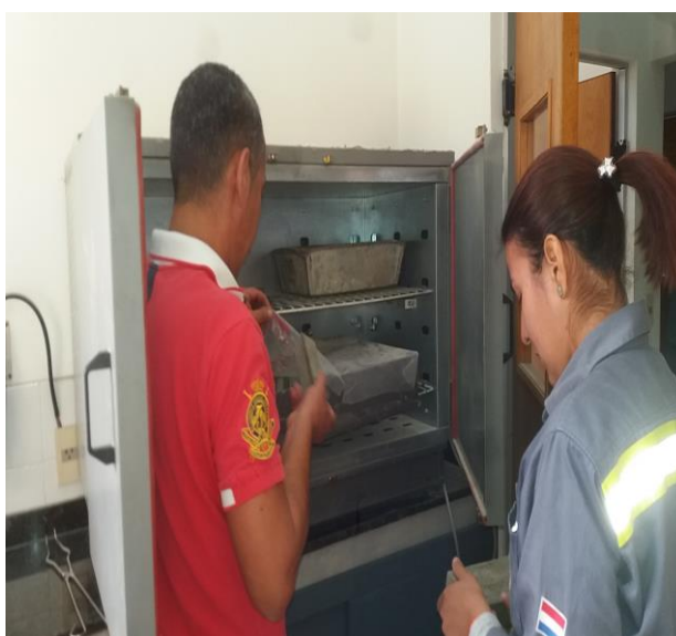
Figura 13. Probetas llevadas a la estufa durante 28 días para la determinación del índice de puzolanidad.
