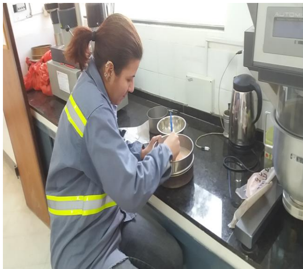
Figura 7. Proceso de tamización de caolín calcinado y puzolana para determinar el índice de puzolanidad.
