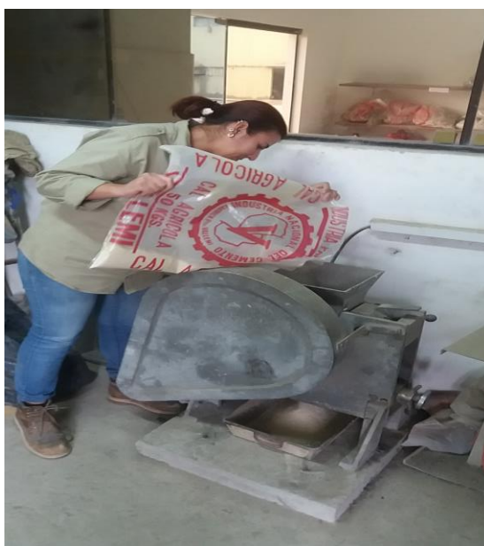
Figura 3. Trituradora empleada para reducir el tamaño de las muestras.
