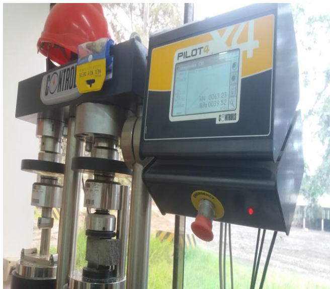
Figura 16. Prensa Hidráulica utilizada para el ensayo físico de resistencia.
