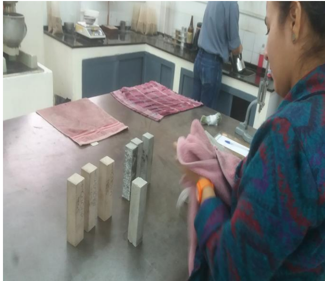
Figura 15. Limpieza y secado de las probetas para realizar el ensayo físico de resistencia.
