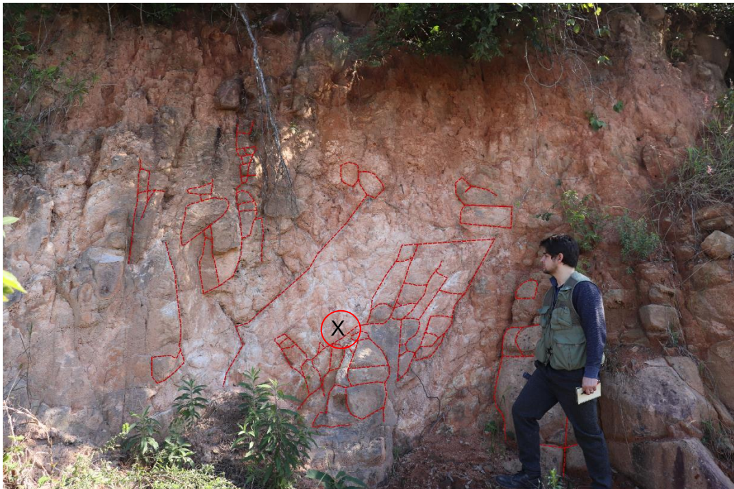
Figura 16. Zona de muestreo de la Cant 2. Se visualiza el sistema de fracturas bordeando los corestones , formando paralelepípedos (marcados con líneas discontinuas rojas).
