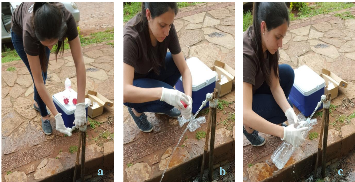
Anexo 9: Toma de muestras del Pozo n° 2 P0144; a. Limpieza de la boca de salida del agua b. Toma de muestra para análisis bacteriológico c. Muestreo para análisis físico-químico.
