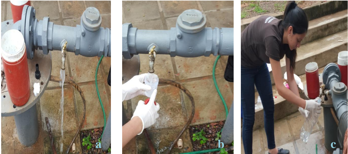
Anexo 12: Toma de muestras del Pozo n° 5 P0426; a. Se dejó correr el agua por unos minutos b. Muestreo para análisis bacteriológico c. Toma de muestra para análisis físico-químico.
