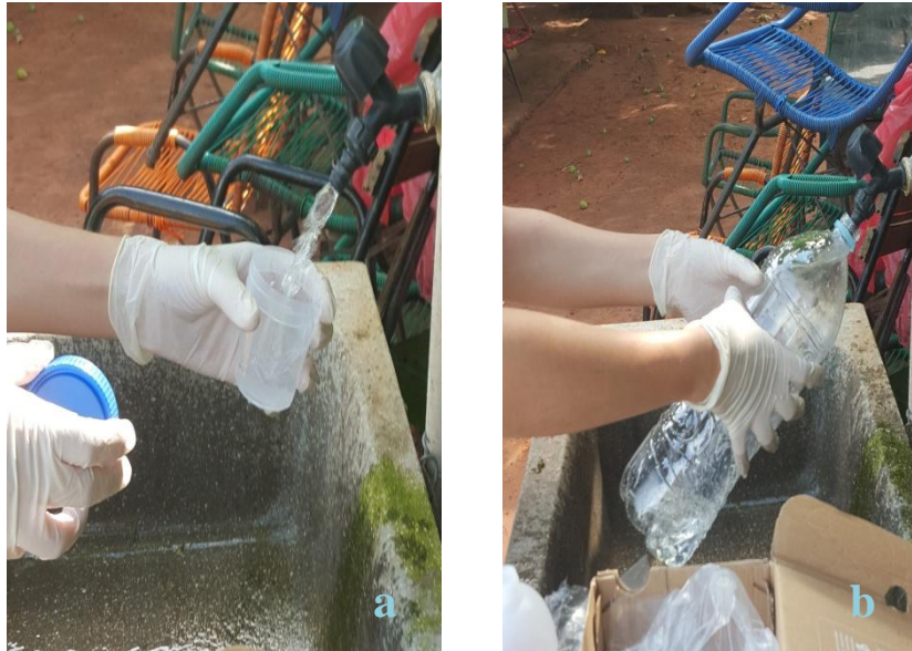
Anexo 8: Toma de muestras del Pozo n° 1 P1010; a. Para análisis bacteriológico b. Para análisis físico-químico.
