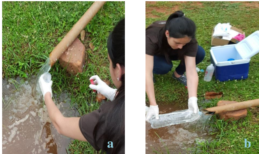
Anexo 13: Toma de muestras del Pozo n° 6 P0050; a. Muestreo para análisis bacteriológico b. Toma de muestra para análisis físico-químico.
