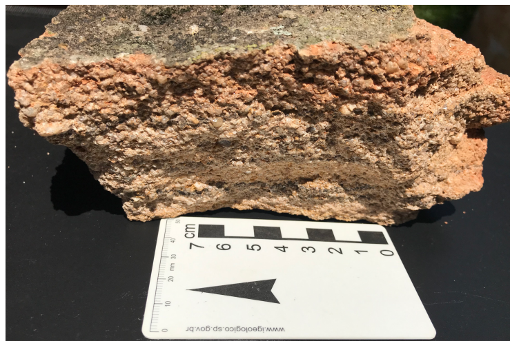
Figura 17. Arenisca de grano grueso a medio correspondiente a los bloques que se encuentra en la cima del talud Fuente: Elaboración propia.
