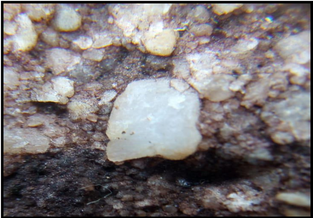
B7. Granos de cuarzo en arenisca conglomeradica a través de una lupa 10X.
