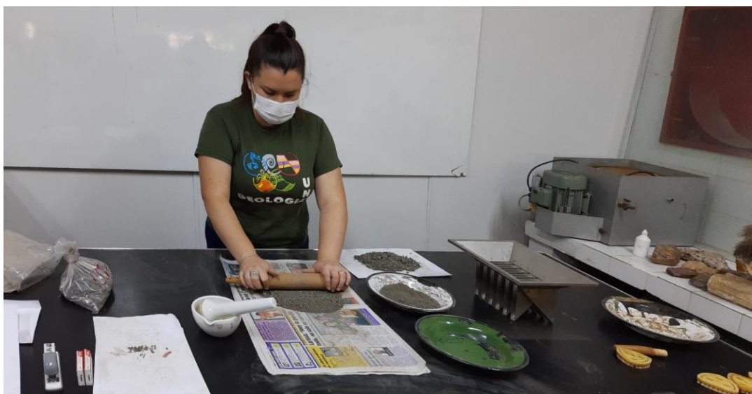
Figura 18. Molienda de muestras de sedimento de la Laguna Cateura.
