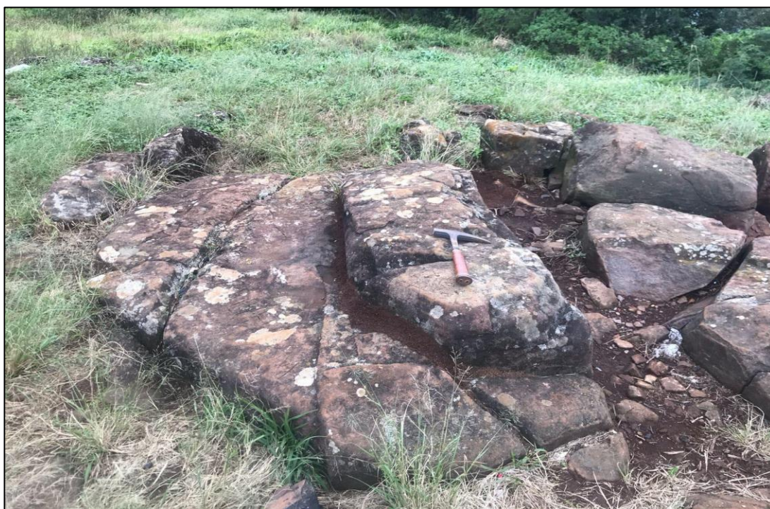
Figura 12 Muestra 1. Basalto toleítico alterado y sumamente fracturado.
