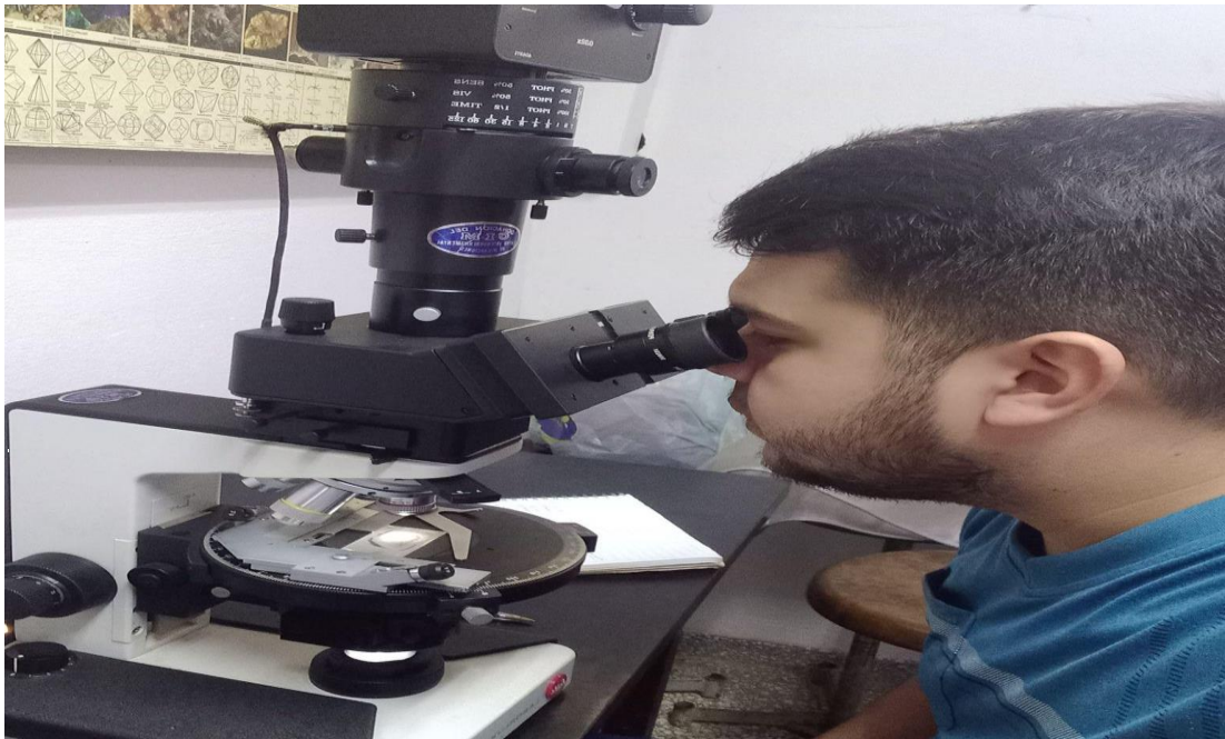
Figura 8 Observación de lámina delgada a través de microscopio petrográfico de la marca Leica .
