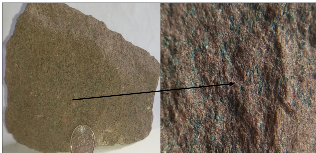
Figura 23 a) Muestra de mano con oquedades rellenas de arcilla. b) Basalto toleítico con oquedades rellenas de material arcilloso. Observado en lupa 20x.
