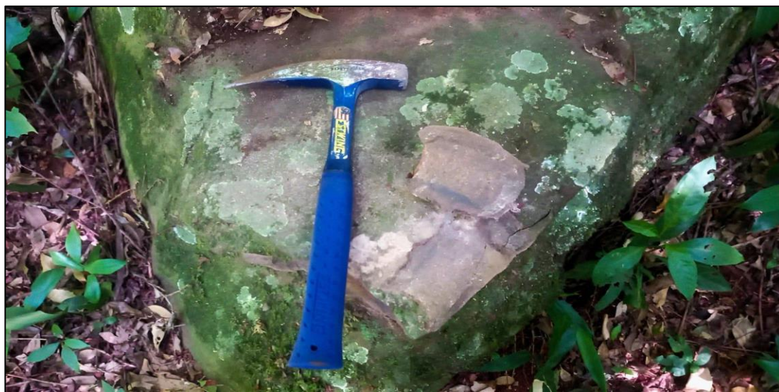
Figura 16 Afloramiento de basalto toleítico con textura afanítica.
