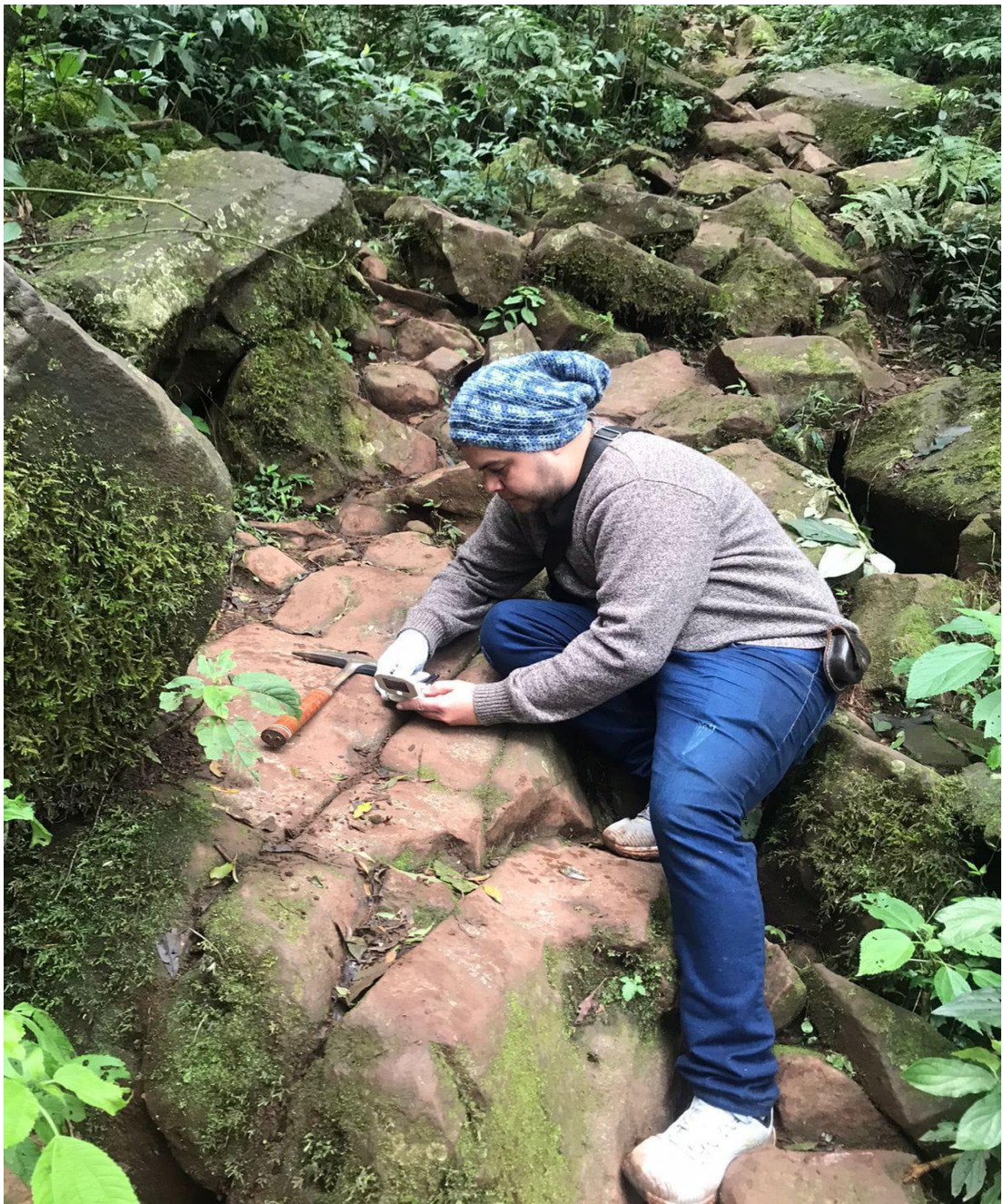
Anexo 5 Medición de rumbo en fracturas presentes en basaltos toleílicos.
