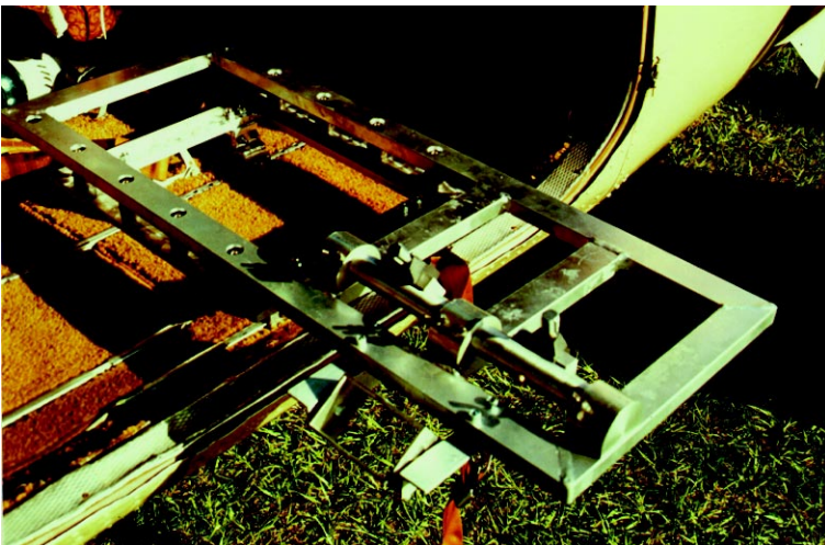
Fig. 2: Soporte de equipos con asiento y puerta desmontada de la Cessna 210
