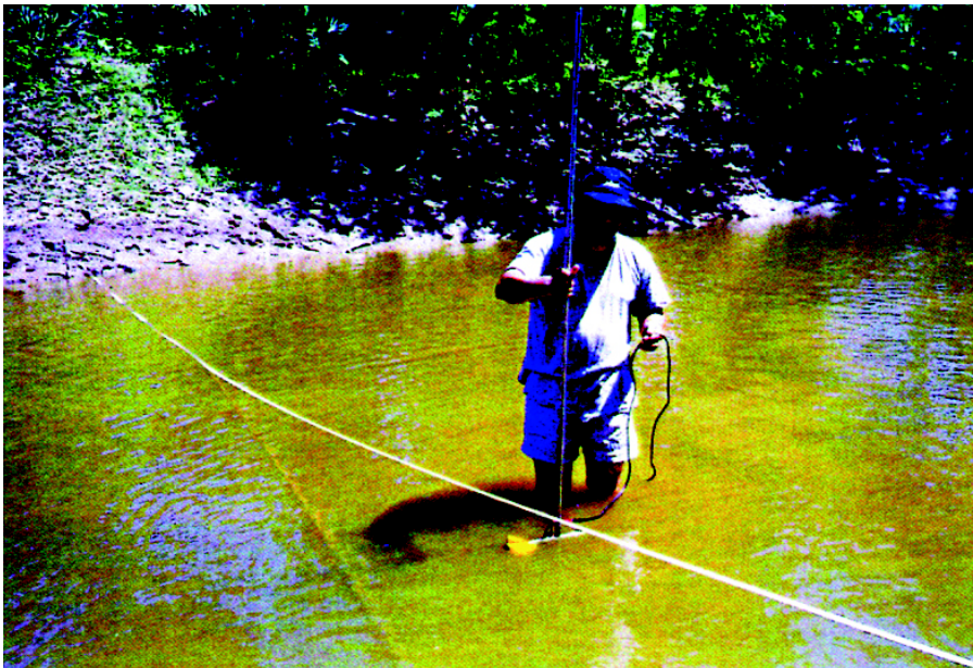
Medición del aforo con molinete en el Río Negro
