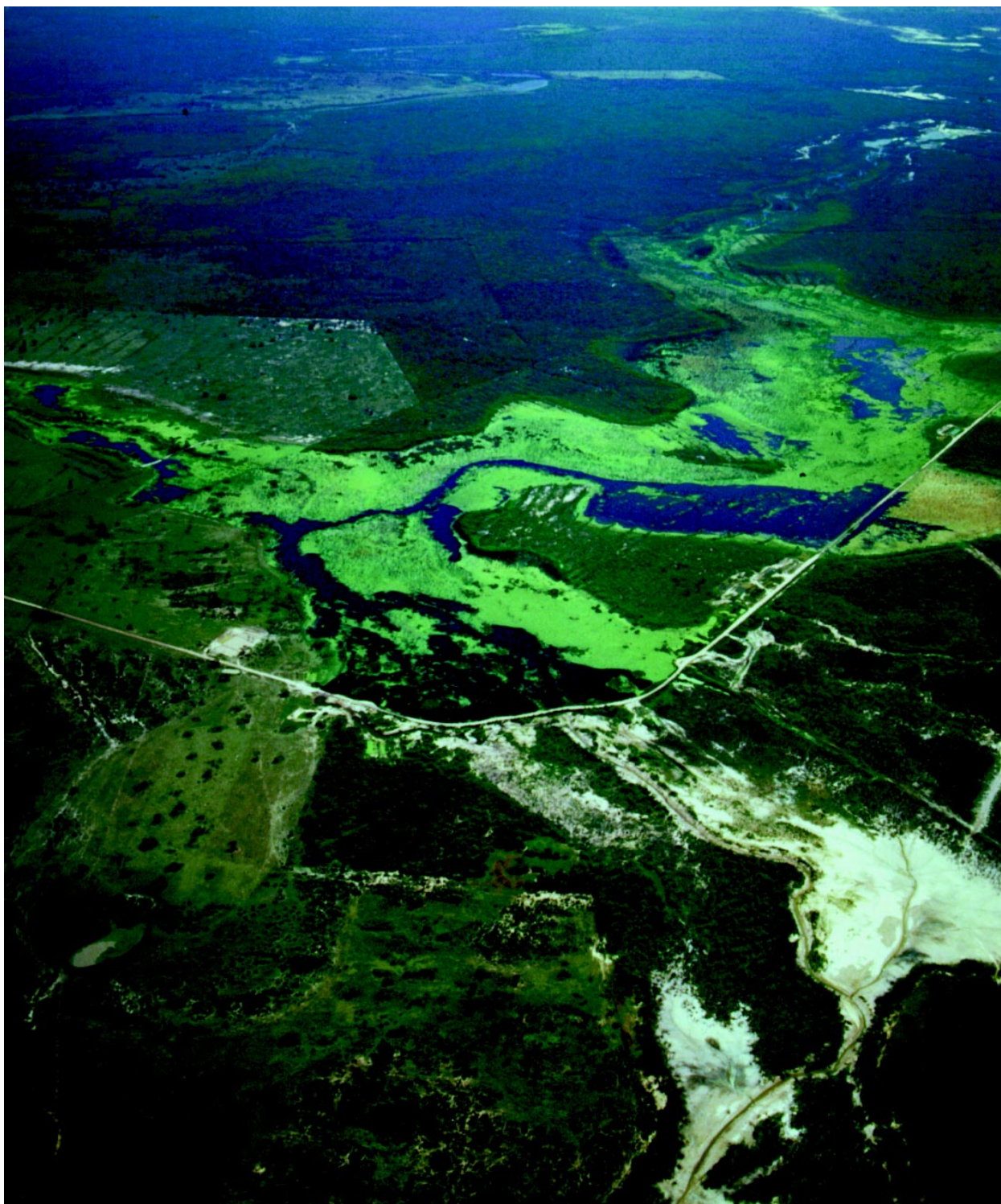
Fig 13: Parte superior del Río Montelindo. La construcción de un camino causa estancamiento de las aguas superficiales (parte superior de la exposición) y llega a la salinización, causada por el alto grado de evaporación y falta de una salida de las aguas (parte inferior de la exposición). Altura de vuelo: 1.350 m.
