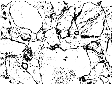
Fig. 19 ARE-1, lámina transparente, LN x 75. Detalle de la preparación: anterior en el que se ve a los granos de cuarzo parcialmente corroídos y reemplazados por el cemento.
